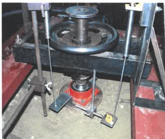
Rys. 4.4. Stanowisko do badań statycznych oddziaływań na miny umieszczone w gruncie [7]: – schemat: 1-układ hydrostatyczny, 2-rama montażowa, 3-płyta naciskowa, 4-skrzynia badawcza, 5-grunt, 6-czujnik przemieszczeń pionowych miny, 7-czujnik przemieszczeń płyty naciskowej, 8-czujnik siły obciążającej układ grunt-mina, 9-czujnik siły w minie, 10-czujnik pionowych przemieszczeń zapalnika [7]
