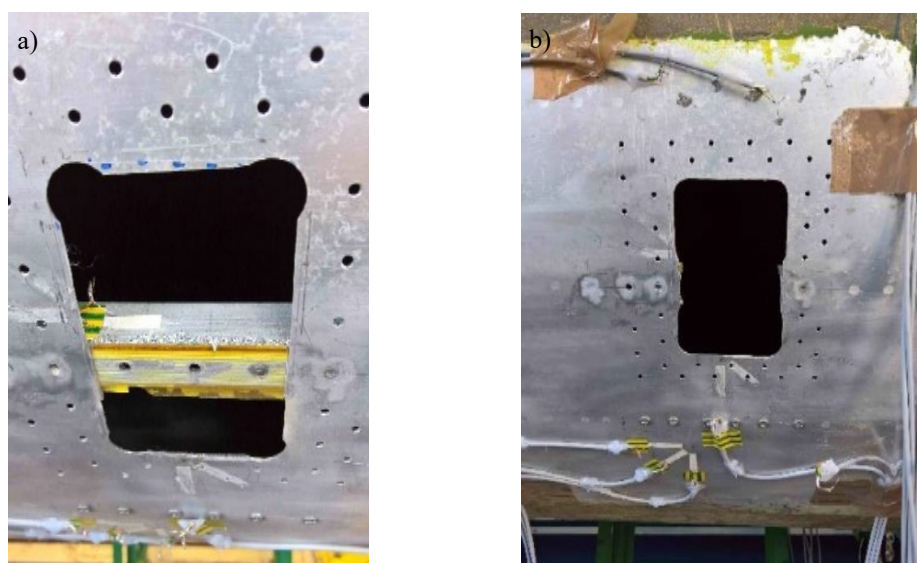
Rysunek 4.24. Badany obszar X: a) z usuniętą blachą pokrycia, b) z usuniętą blachą pokrycia i fragmentem podłużnicy nr 5
