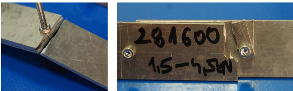
Rysunek 3.9. Widok postaci zniszczenia połączenia mechanicznego w wariancie montażu łączników 1d
