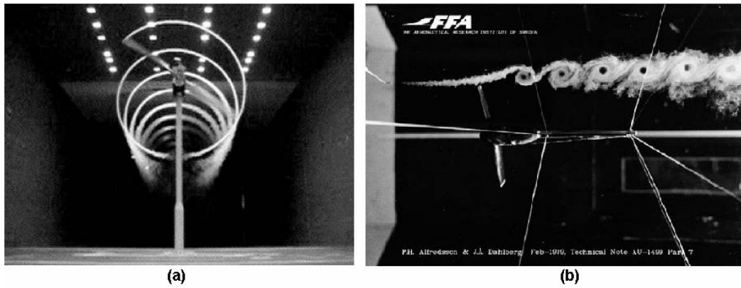
Rys. 31. Wizualizacja wiru wierzchołkowego 2-łopatowego śmigła. (a) – [44], (b) – [45]
