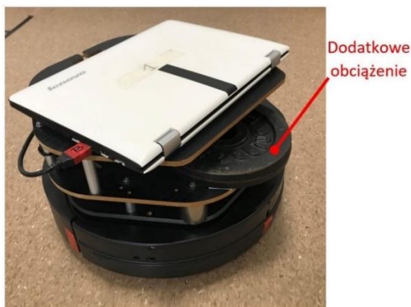
Rys. 2.3. Zmodyfikowana konstrukcja robota TURTLEBOT 2
