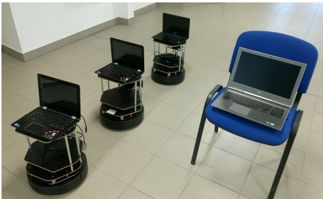
Rys. 3.1. Widok stanowiska badawczego grupy robotów TURTLEBOT 2
