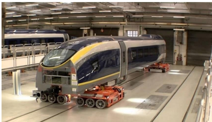
Rys. 1.2. System transportowy KUKA omniMove w fabryce pociągów SIEMENS [58]
