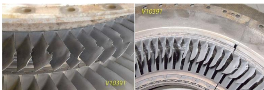
Rysunek 1.13. Uszkodzenia 6 stopnia sprężarki wysokiego ciśnienia silnika V2533 (z lewej: wieniec wirnikowy, z prawej: wieniec kierownic) [41]
