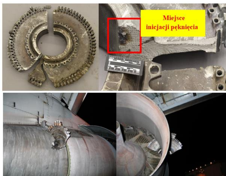
Rysunek 1.10. Tarcza wirnika turbiny wysokiego ciśnienia rozerwana wskutek zmęczenia materiału wynikającego z wady materiałowej) [37]
