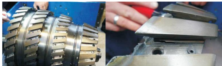
Rysunek 1.9. Pęknięcie zmęczeniowe wirnika sprężarki niskiego ciśnienia w rejonie wieńca [36]
