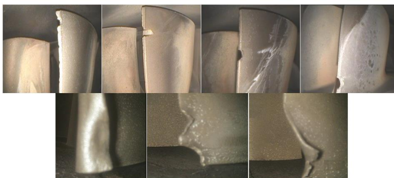
Rysunek 1.7. Przykładowe uszkodzenia łopatek sprężarki lotniczych silników turbinowych
