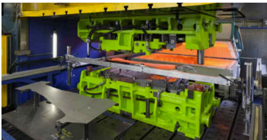
Rys. 5. Widok oprzyrządowania i wytłoczki do hartowania w procesie tłoczenia stali typu HF [19]
