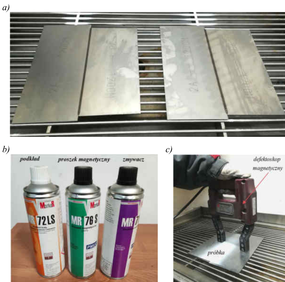
Rys. 45. Widok przykładowych półfabrykatów a), zastosowanych preparatów w badaniu MT b) oraz widok defektoskopu magnetycznego podczas badania c)
