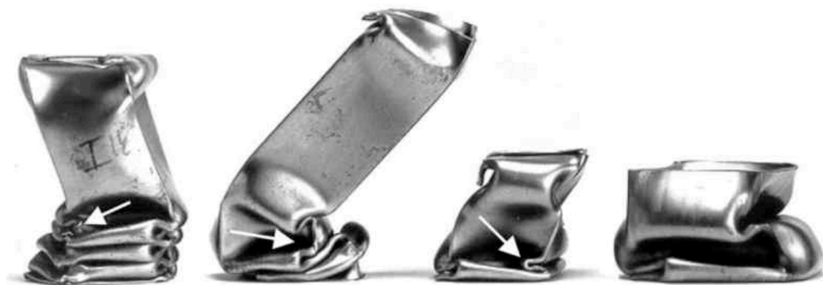
Rys. 19. Globalne wyboczenie absorberów bez inicjatorów zgniotu, strzałkami zaznaczono miejsca niesymetrycznego składania się konstrukcji [116]
