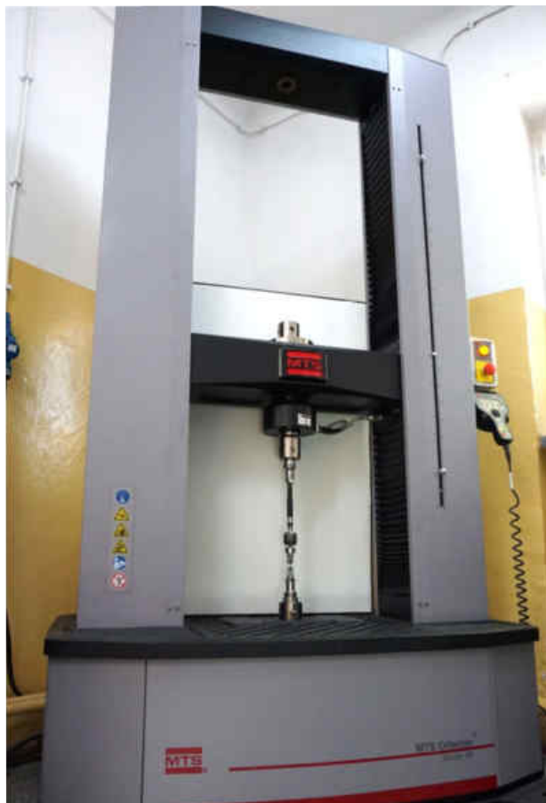
Rys. 47. Maszyna wytrzymałościowa MTS Criterion 45 a) oraz widok uchwytów mocujących próbkę materiałową po jej zerwaniu b)
