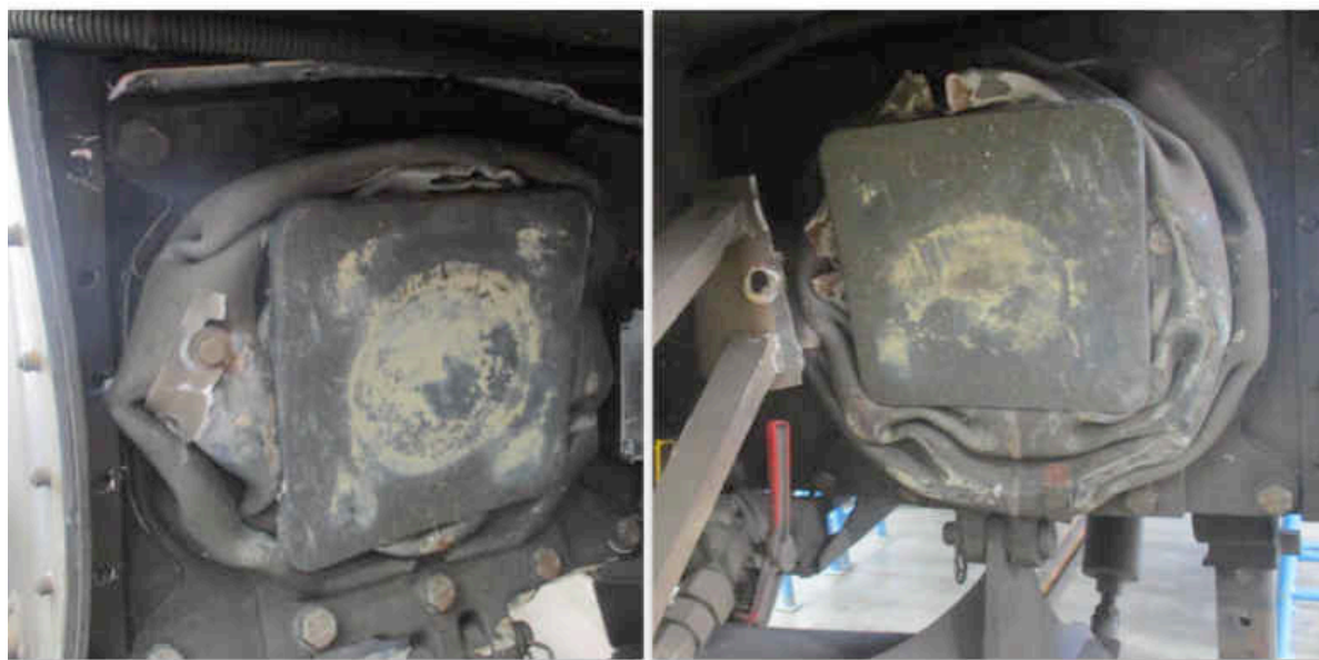
Rys. 17. Widok absorberów energii mechanicznej stosowanych w pojeździe szynowym po zderzeniu z przeszkodą (fot. Paweł Prochenka, Siedlce, 2017 r.)
