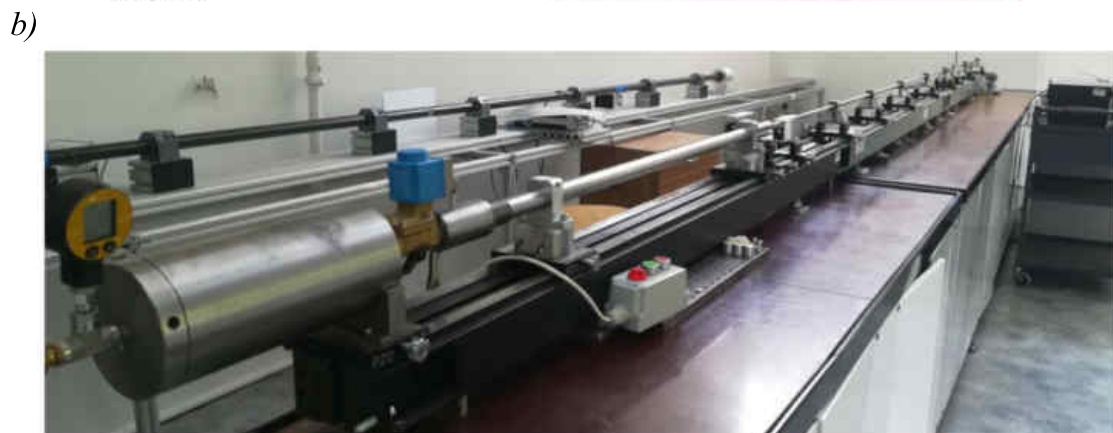
Rys. 48. Stanowisko do testów dzielonego pręta Hopkinsona, schemat wariantu na rozciąganie z widocznymi uchwytami i próbka a) oraz rzeczywisty widok stanowiska badawczego b)
