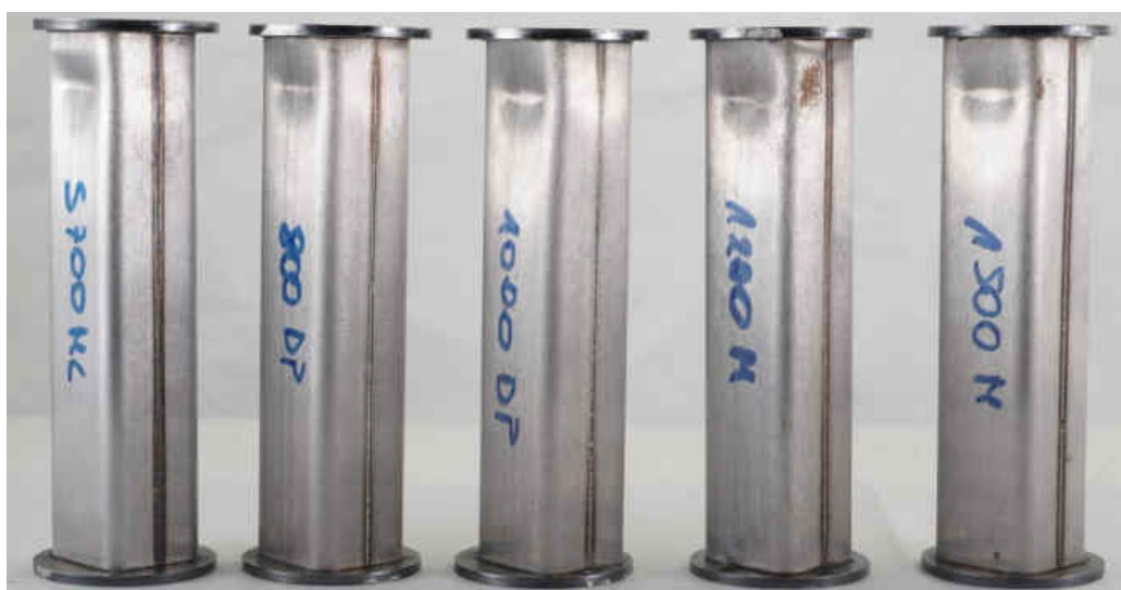
Rys. 37. Widok miniaturowych absorberów energii mechanicznej z przyklejonymi podkładkami ochronnymi
