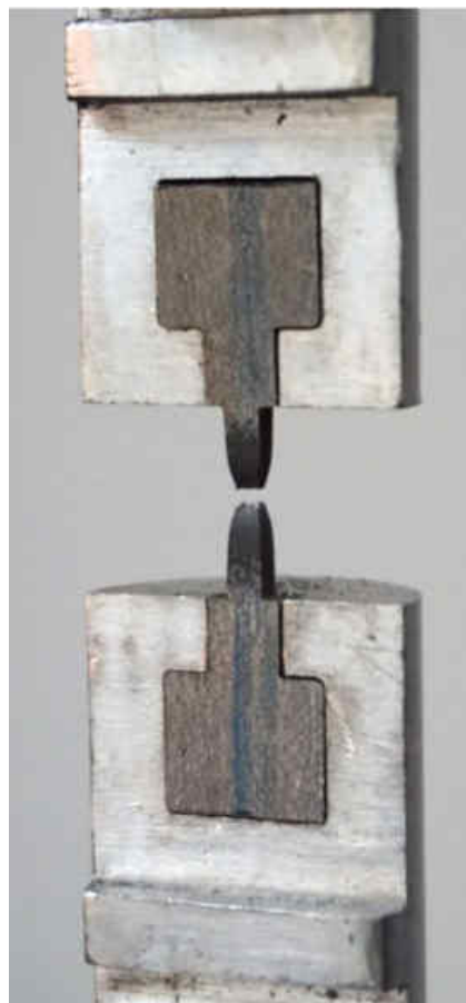
Rys. 47. Maszyna wytrzymałościowa MTS Criterion 45 a) oraz widok uchwytów mocujących próbkę materiałową po jej zerwaniu b)
