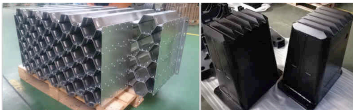
Rys. 24. Widok absorberów energii mechanicznej stosowanych w pojazdach szynowych (fot. Paweł Prochenka, Siedlce, 2016 r.)
