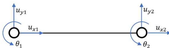
Rys. 2.25 Schemat elementu belkowego w dwuwymiarowym układzie współrzędnych z ukazaniem stopni swobody w węzłach
