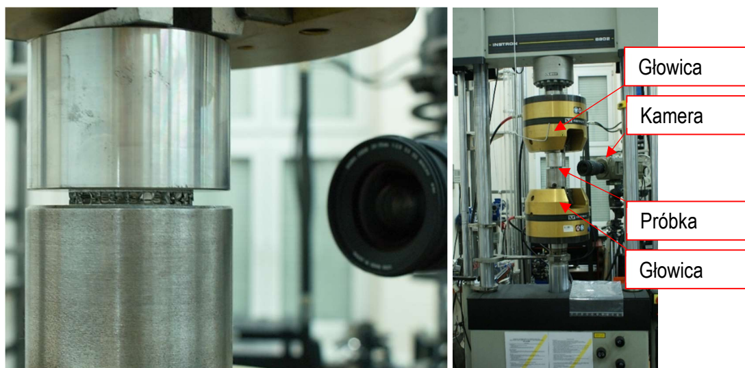
Rys. 3.2 Maszyna INSTRON 8802 przygotowana do badań
