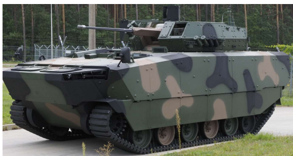
Rys. 1.10 Przykład płaskodennego pojazdu gaśnicowego chronionego przed wybuchem min i IED [43, materiały autora]
