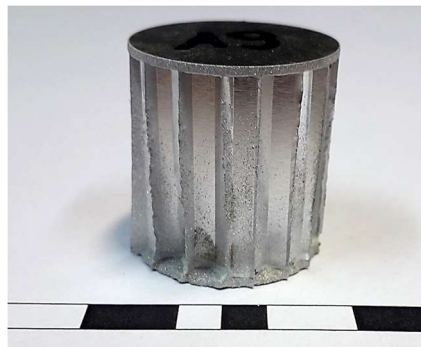
Rys. 4.15 Próbkki wykonane z ALUCORE® i IMATEC® 3/16-5052-.0015
