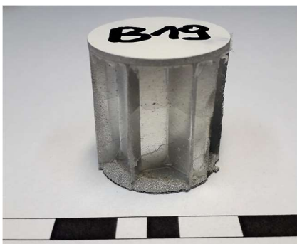
Rys. 4.15 Próbkki wykonane z ALUCORE® i IMATEC® 3/16-5052-.0015
