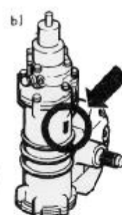
Rys. 1-10. Miejsce znakowania przekładni kierowniczej: a) typu ZF, b) typu ZIL
