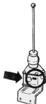
Rys. 1-13. Miejsce znakowania dźwigni zmiany biegów
