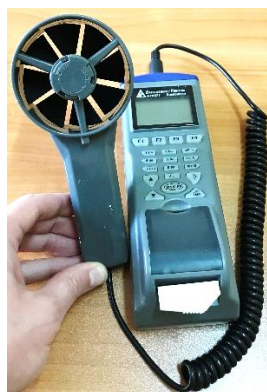
Rysunek 3. Anemometr czasowy - z lewej, Anemometr skrzydełkowy - z prawej.
