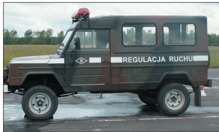
Fot. 5. Wojskowe pojazdy uprzywilejowane wyposażone w niebieskie i dodatkowo czerwone światło błyskowe, stosowane są do zabezpieczania przejazdów wojskowych wymagających pilotowania.
