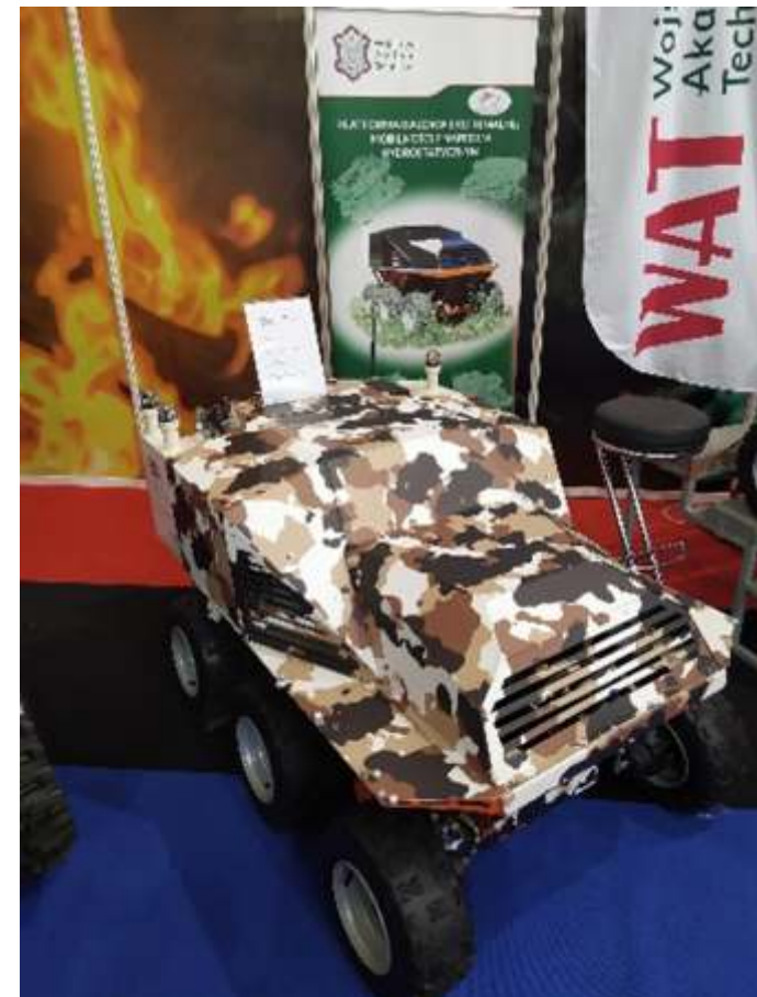
Platforma Bazowa Ekstremalnej Mobilności z Napędem Hydrostatycznym – ExMot
