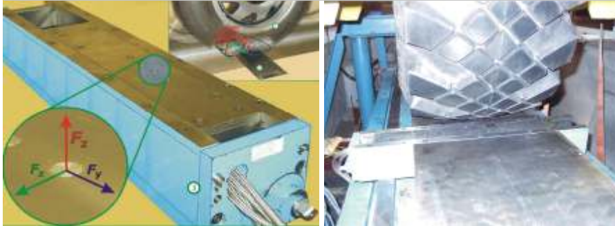
Głowica podczas pomiaru sił obciążających występy bieżnika opony wielkogabarytowej
