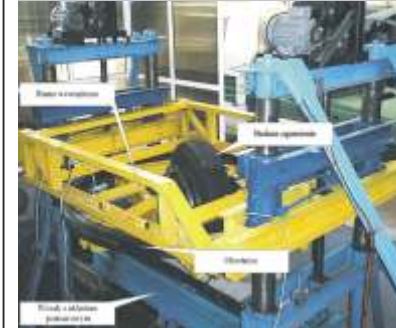
Głowica podczas pomiaru sił obciążających występy bieżnika opony wielkogabarytowej
