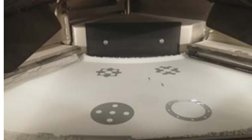
Urządzenie do wytwarzania przyrostowego techniką selektywnego spiekania wiązką lasera – EOS Formiga P110
