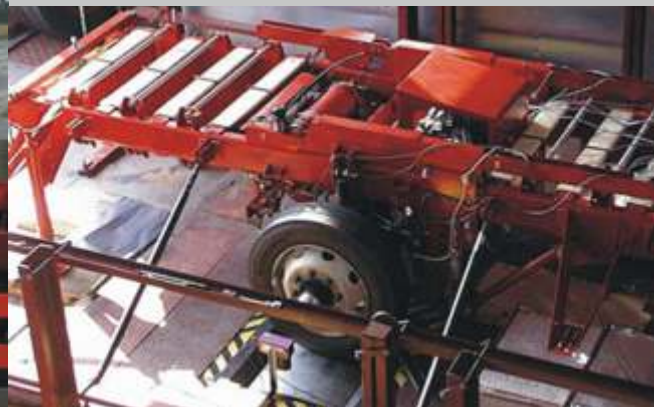
Przyczepa dynamometryczna podczas pomiarów drogowych i badań laboratoryjnych
