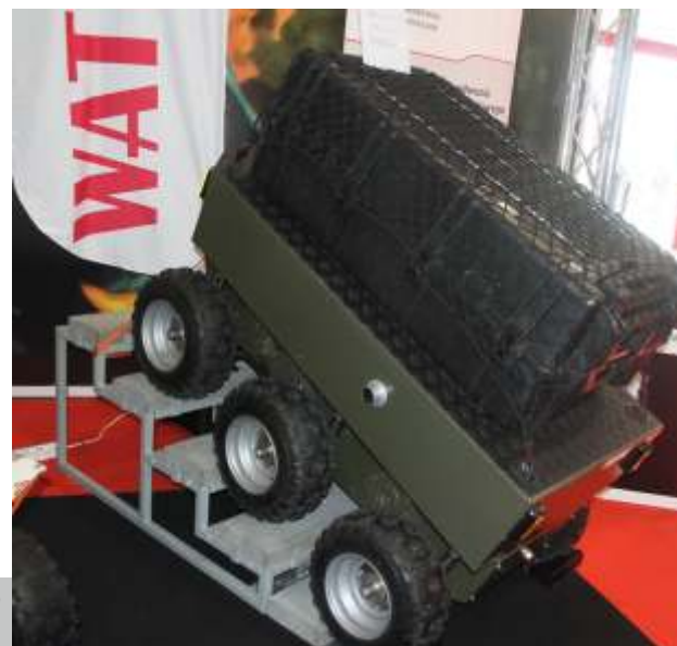
Wielofunkcyjne podwozie bezzałogowego pojazdu lądowego z napędem hybrydowym
