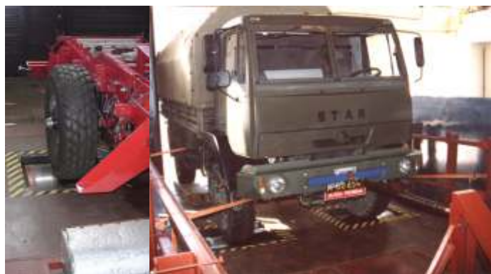
Stanowisko dwubębnowe podczas pomiarów (z ustawioną przyczepą dynamometryczną i badanym pojazdem)
