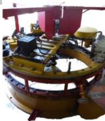
Czołg T-72M1 przygotowany do badań stabilizacji armaty
