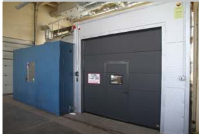
Stanowisko dynamometryczne w wykonaniu Ex do badania silników zasilanych CNG
