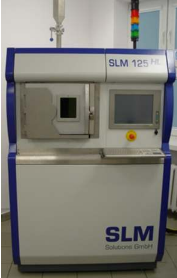
Urządzenie do wytwarzania przyrostowego techniką selektywnego stapiania wiązką lasera – SLM 125HL
