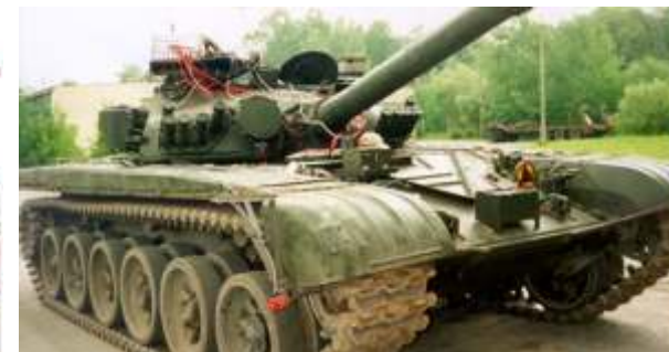
Czołg T-72M1 przygotowany do badań stabilizacji armaty
