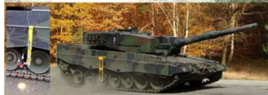
Pomiar obciążeń dynamicznych kadłuba platformy Anders podczas strzelania (góra) oraz badanie procesu rozpędzania i hamowania czołgu leopard 2A4 (dół)
