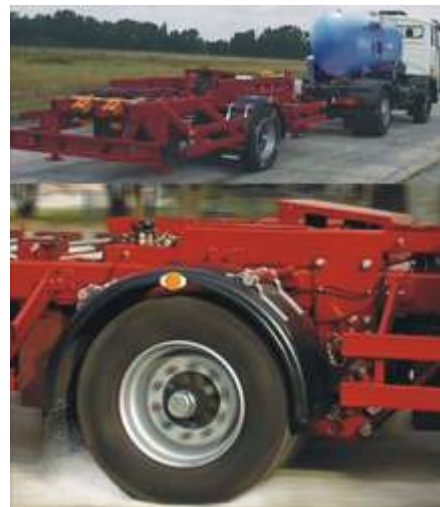
Przyczepa dynamometryczna podczas pomiarów drogowych i badań laboratoryjnych
