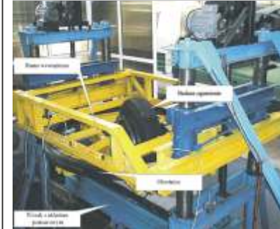
Opona 14.00R20 odkształcona podczas badań charakterystyki sprężystości promieniowej
