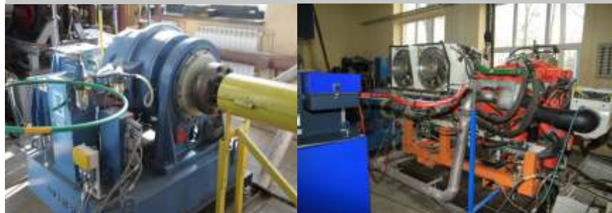
Stanowiska dynamometryczne do badań silników spalinowych
