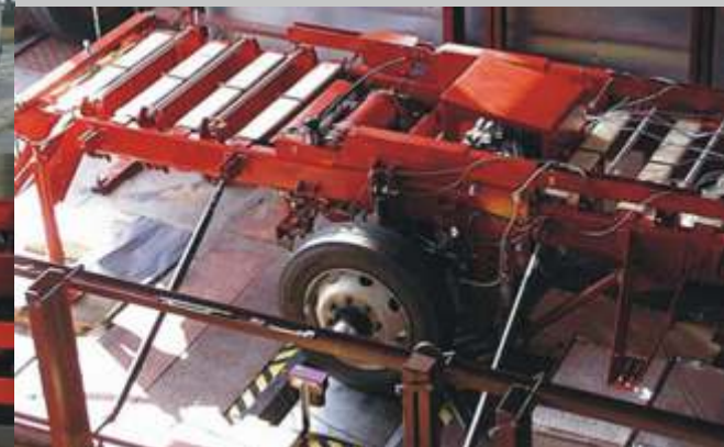
Przyczepa dynamometryczna podczas pomiarów drogowych i badań laboratoryjnych
