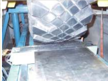
Głowica podczas pomiaru sił obciążających występy bieżnika opony wielkogabarytowej
