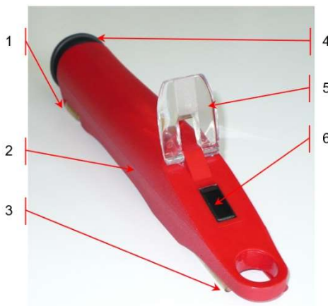
Rysunek 24.1 Widok refraktometru do badania temperatury krystalizacji cieczy chłodzących (1 – gruszka zakraplacza, 2 – korpus, 3 – zakraplacz do pobierania cieczy chłodzącej, 4 – okular z osłoną, 5 – pokrywa pryzmki, 6 – pryzmat)
