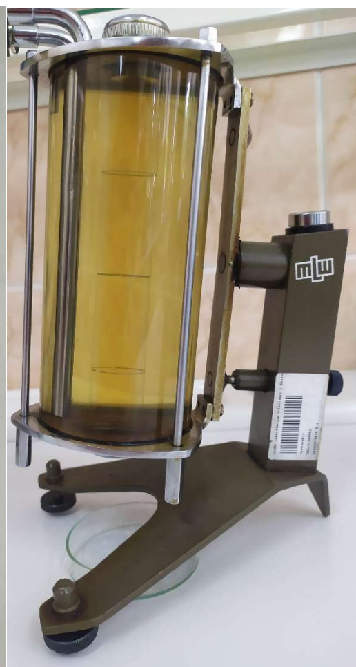
Rysunek 21.1 Lepkościomierz Hopplera (1 – szklana rurka pomiarowa z kreskami A i B w odległości 100mm od siebie i trzecią kreską dzielącą AB na połowy, 2 – cylindryczny płaszcz szklany, 3 – rura wlotowa z otworem dla cieczy termostatujucej, 4 – rura wylotowa dla cieczy termostatujucej, 5 – nakrętka kołpakowa stosowana zamiast króćca, 6 i 7 – króćce, 8 – śruba odpowietrzająca, 9 – korek z metalu z uszczelką lub korek z kauczuku butadienowego, 10 – uszczelka z kauczuku butadienowego, 11 – nakrętki kołpakowe na rurę pomiarową, 12 – korek metalowy wydrążony, 13 – kapilara, 14 – pokrywa na korek metalowy, 15 – grzałka, 16 – gwintowany otwór na termometr, 17 – poziomica, 18 – statyw, 19 – kulka, 20 – zapadka mocująca płaszcz 2, 21 – śruby poziomujące 22 – trzpień łączący płaszcz ze statywem 18 o konstrukcji umożliwiającej obracanie płaszcza o kąt 180 °)
