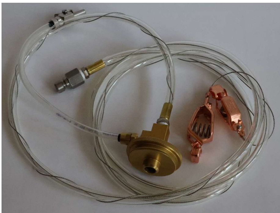
Rysunek 28.10. Dolna obudowa monitora wraz z przewodami i elementami uziemienia (szczęki uziemiające do podłączenia)
