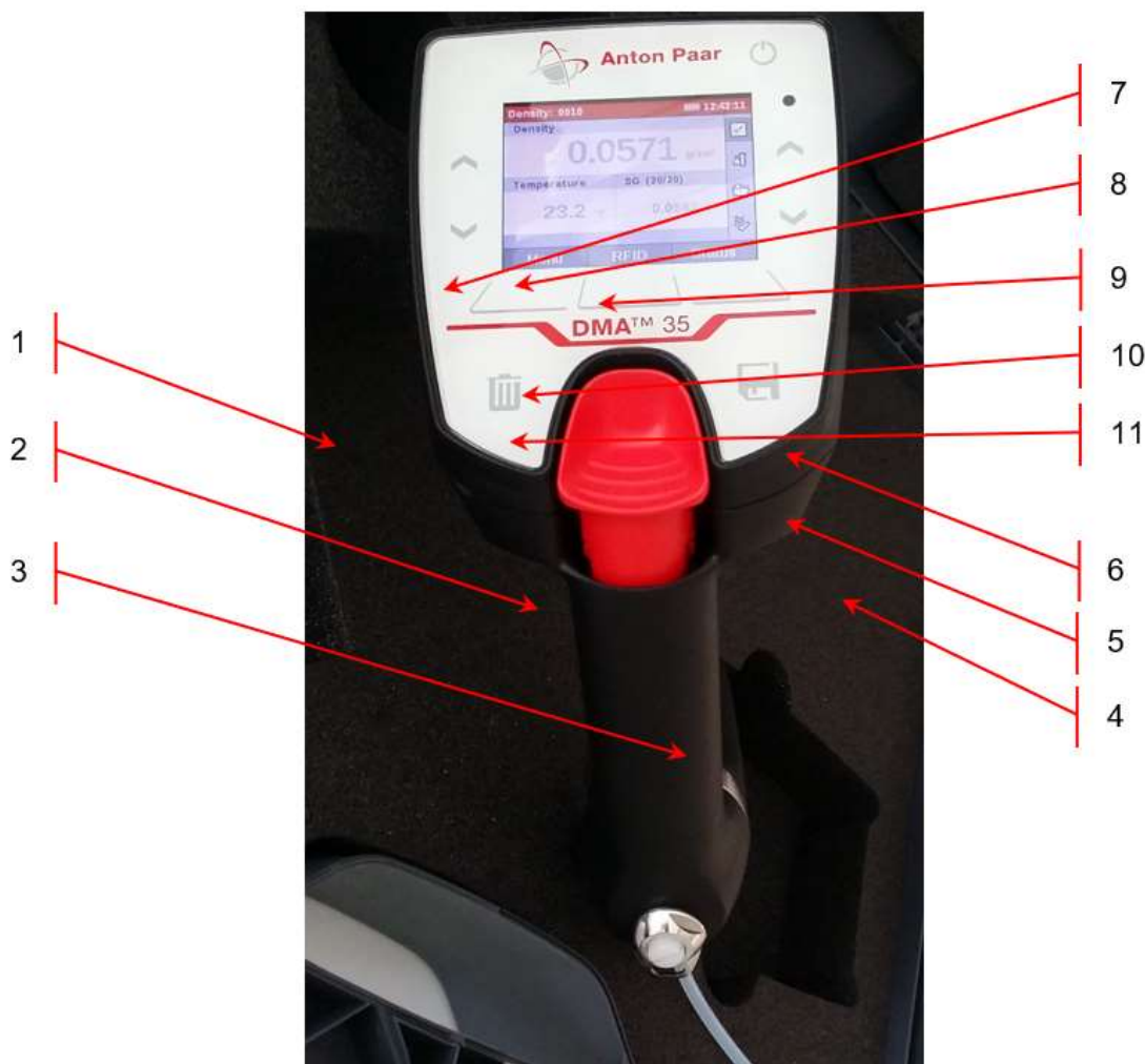
Rysunek 2.1 Widok gęstościomierza elektronicznego DMA 35N (1 – wyświetlacz, 2 – komora pomiarowa, 3 – rurka do napełniania, 4 – zatyczka wkręcana, 5 – pompa, 6 – blokada pompy, 7 – przycisk operacyjny „ON/OFF”, 8 – przycisk operacyjny „Recal/Delete”, 9 – przycisk operacyjny „Print/Print all”, 10 – zmierzona gęstość próbki, 11 – temperatura próbki)
