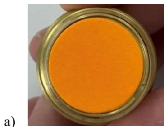
Rysunek 27.5. Wkład filtracyjny (widok ułożenia wkładu w dolnej części obudowy)
