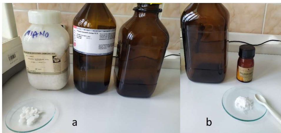
Rysunek 9.2 Substancje użyte do stworzenia KOH (a) i badania miana (b). Trzecia butelka (a) oraz 1 pierwsza butelka (b) gotowe KOH.
