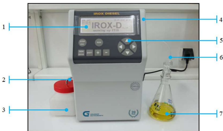
Rysunek 29.1 Widok Irox Diesel firmy Grabner Instruments (1 – wyświetlacz, 2 – przewód odprowadzający próbkę ON po badaniu, 3 – pojemnik na zlewki paliwa po badaniu, 4 – Irox Diesel, 5 – panel z przyciskami operacyjnymi, 6 – przewód do pobierania próbki ON, 7 – próbka badanego ON)
