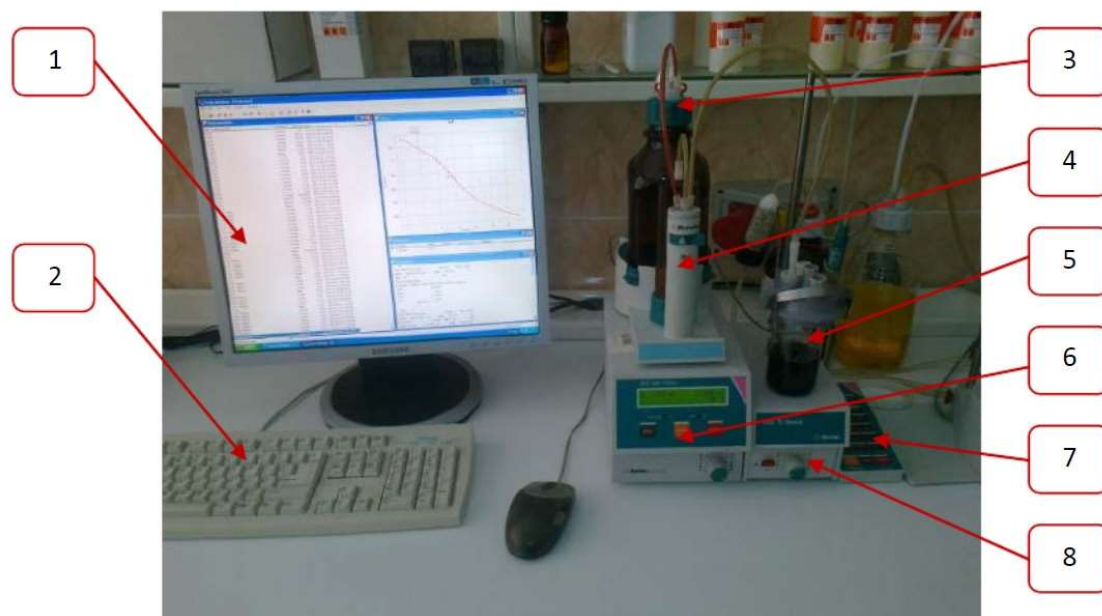
Rysunek 9.1 Stanowisko do badania liczby kwasowej - aparat 702 SM Titrino firmy Metrohm z wyposażeniem (1 - monitor komputera z programem rejestrującym, 2 - klawiatura komputera, 3 - butelka z roztworem do miareczkowania - 0,1 mol/l roztwór alkoholowy KOH, 4 - biureta automatyczna, 5 - zlewka o pojemności 150 cm 3 z roztworem badanej próbki i elektrodą pomiarową, 6 - aparat 702 SM Titrino, 7 - klawiatura sterująca aparatu, 8 - mieszało magnetyczne)
