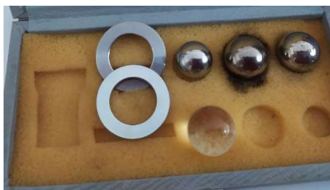
Rysunek 21.3 Komplet kulek i pierścionków do badania lepkości dynamicznej
