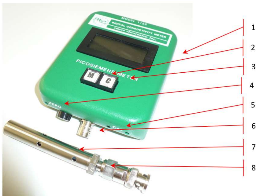
Rysunek 13.1 Cyfrowy miernik przewodności (1 – konduktometr, 2 – przycisk pomiaru („M”), 3 – przycisk kalibracji („C”), 4 – otwór zerowania („Zero”), 5 – otwór kalibracji („Calibrate”), 6 – gniazdo do podłączenia końcówki pomiarowej, 7 – końcówka pomiarowa, 8 – położenie numeru kalibracyjnego)
