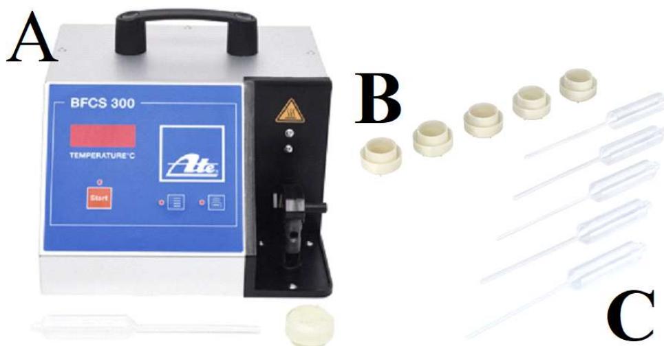
Rysunek 25.1 Urządzenie BFCS 300 do badania temperatury wrzenia płynów hamulcowych (A) z zestawem pojemników (B) i pipet (C)
