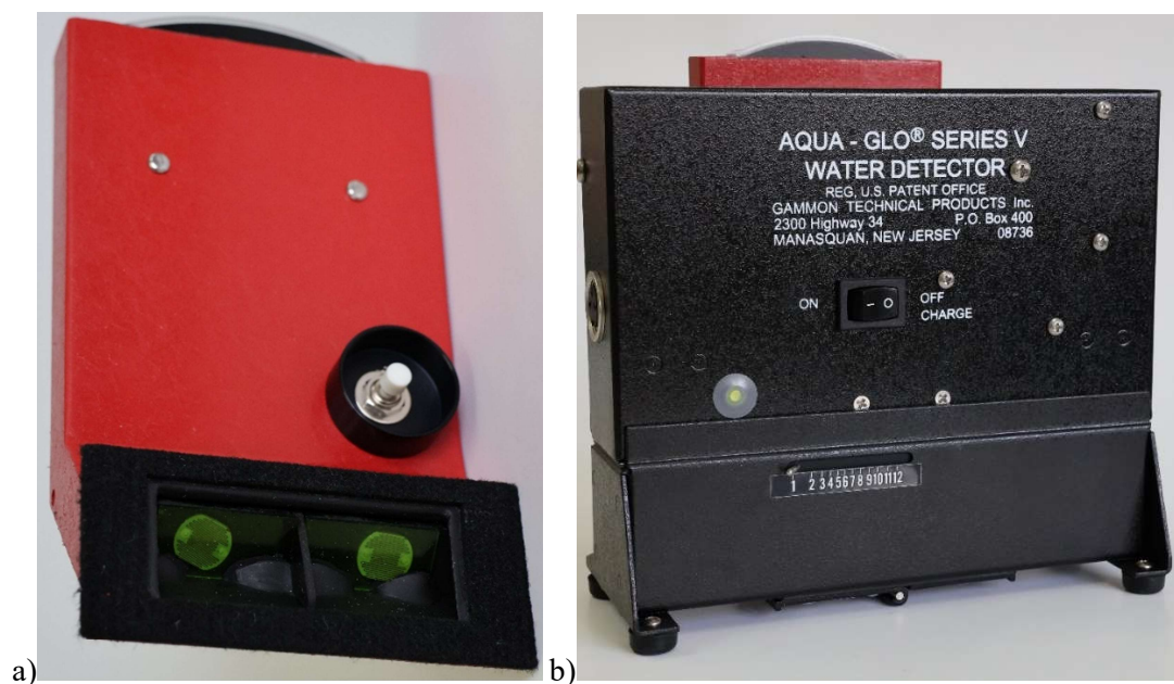
Rysunek 27.7. Analizator Agua Glo V: a) widok przycisku, b) widok urządzenia i dźwigienki
