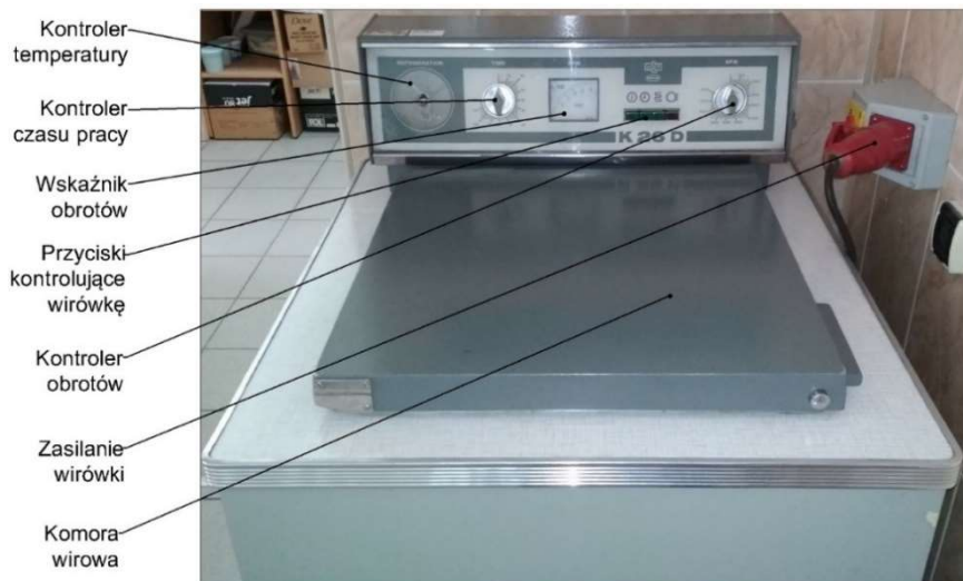
Rys. 25 Widok wirówki K 26D do oznaczania zawartości zanieczyszczeń
