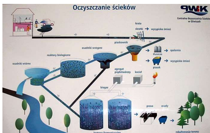
Rys. 6 Schemat oczyszczania ścieków
