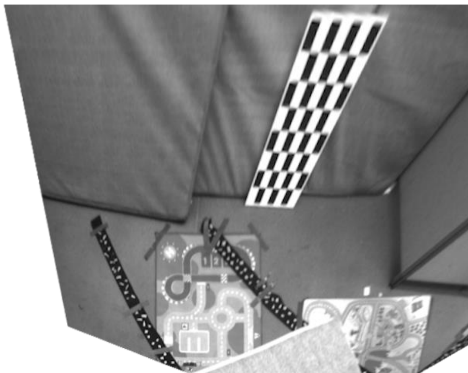
Rys. 6.2.5 Efekt rzutowania obrazu kamery na płaszczyznę równoległą do podłogi pomieszczenia
