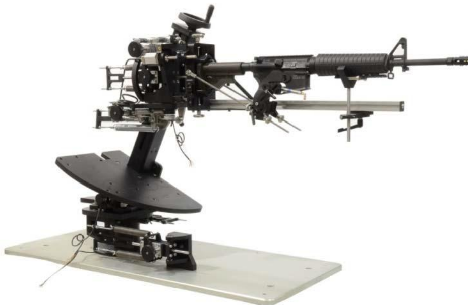
Fot. 1.1. Stanowisko laboratoryjne do badania odrzutu broni strzeleckiej [15]
