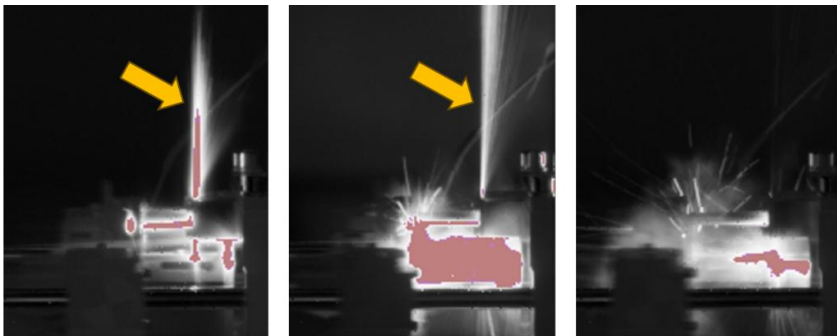
Fot. 4.5. Wybrane klatki z zapisu szybkiej kamery termowizyjnej, które ujawniły wadę działania uszczelnienia tłoczyska (strzałką zaznaczono strumień gazów prochowych przedostający się w miejscu i kierunku nieprzewidzianym w projekcie)
