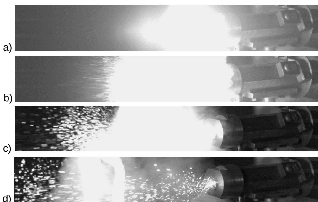
Fot. 17. Zarejestrowane kadry, na których zobrazowano wypływ produktów spalania masy zapłonowej spłonki w czasie: a) 0,2 ms od chwili uderzenia iglicy w spłonkę, b) 0,4 ms od chwili uderzenia iglicy w spłonkę, c) 1 ms od chwili uderzenia iglicy w spłonkę, d) 2 ms od chwili uderzenia iglicy w spłonkę [77]
