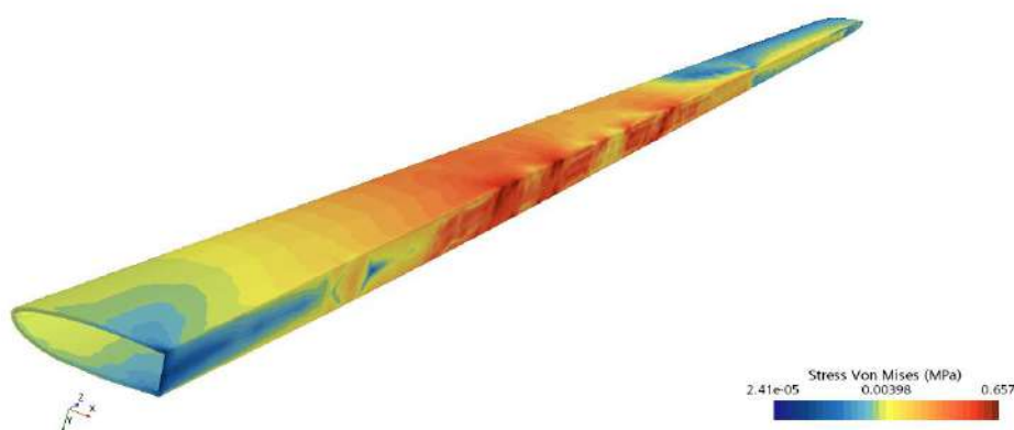
Rys. 18. Naprężenia w modelu MES dźwigara łopaty
