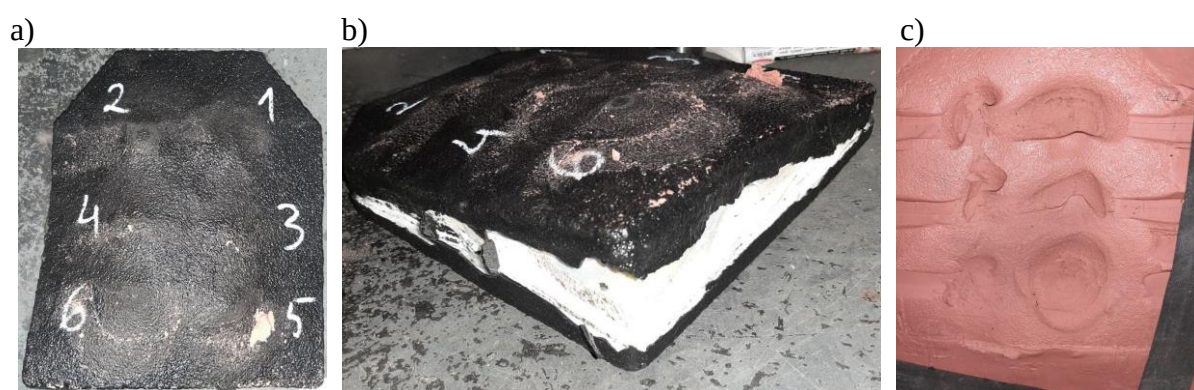
Rys. 5.13. Zdjęcie próbki P22/017 po ostrzale. a) widok z tyłu, b) widok z tyłu od narożnika, c) podłoże balistyczne
