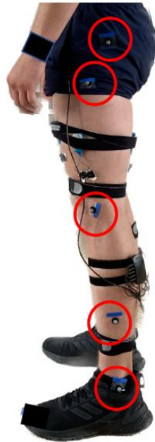
Rys. 4. Sposób rozmieszczenia znaczników referencyjnych do analizy ruchu (źródło: opracowanie własne na podstawie [P2])
