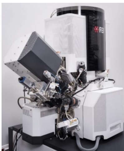
Rys. 4.24. Skaningowy mikroskop elektronowy DualBeam SEM/PFIB Helios 5 PFIB CXe (Nanores, Wrocław) [47]
