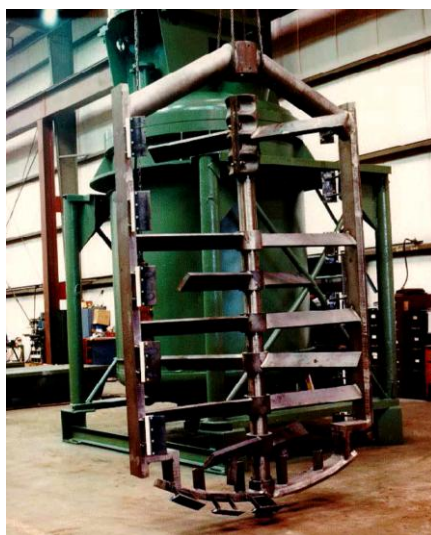
Rys. 1.4. Mieszadło stosowane w procesie wytwarzania smarów plastycznych [84]
