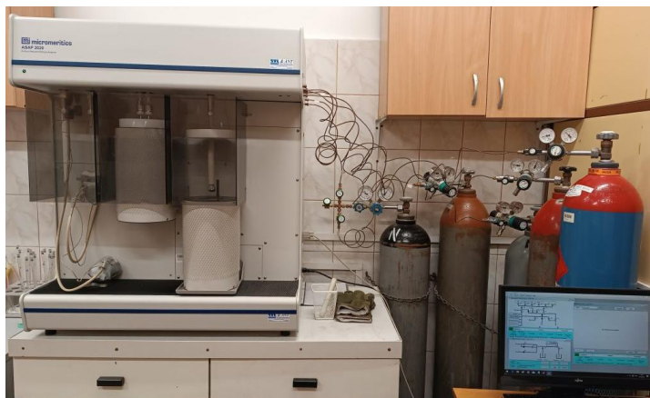
Rys. 4.5. Objętościowy analizator adsorpcyjny ASAP 2020 (Instytut Chemii, WAT)
