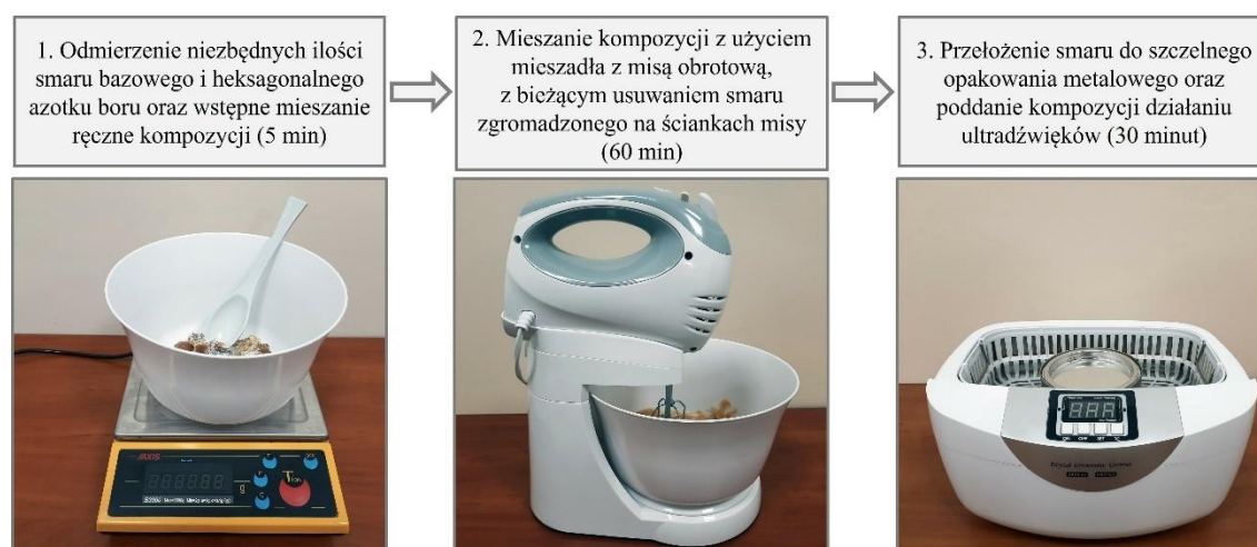
Rys. 3.6. Schemat procedury przygotowania smarów plastycznych z domieszką h-BN
