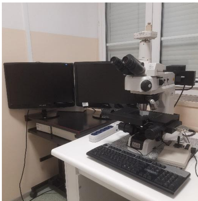
Rys. 4.25. Mikroskop świetlny Nikon Eclipse LV 100D (Zakład Materiałów Pędnych i Smarów, WAT)
