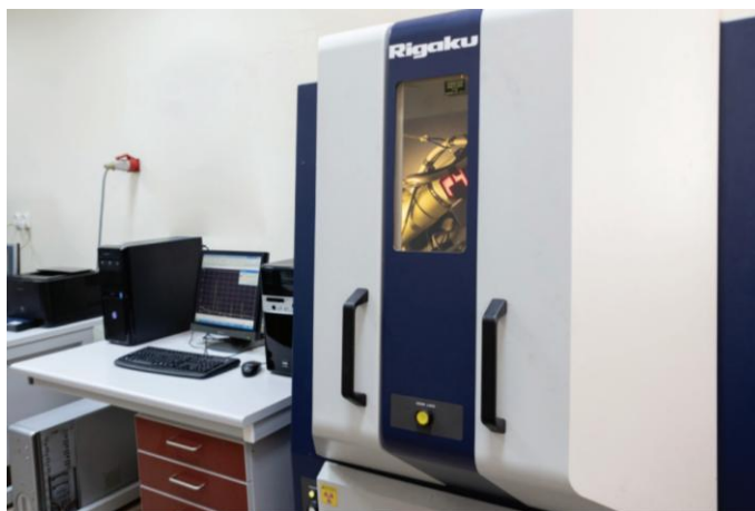
Rys. 4.2. Dyfraktometr rentgenowski Rigaku Ultima IV (Instytut Inżynierii Materiałowej, WAT)
