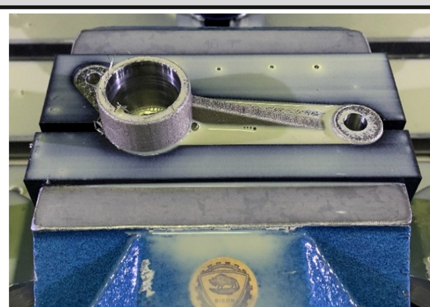
Rys. 8. Dźwignia wykonana w szczękach polimerowych
