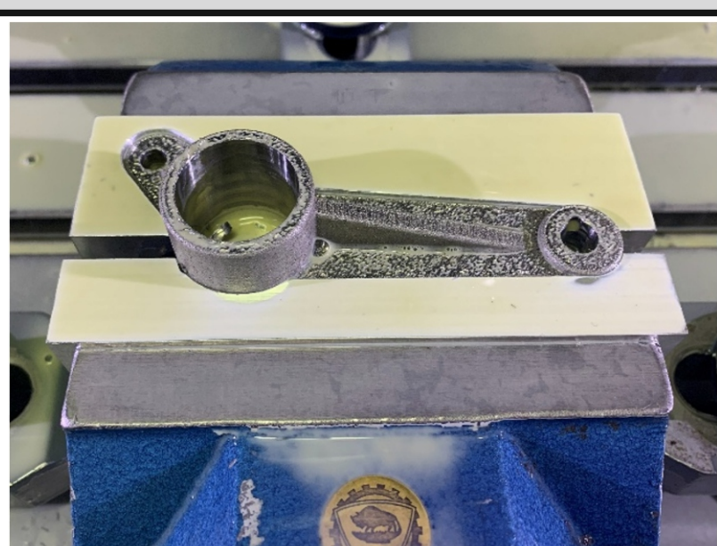
Rys. 7. Dźwignia wykonana w szczękach aluminiowych
