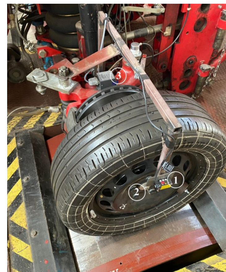
Czujniki zamontowane na kole: 1) czujnik laserowy pomiaru promienia dynamicznego, 2) enkoder inkrementalny, 3) przetwornik przyspieszenia
