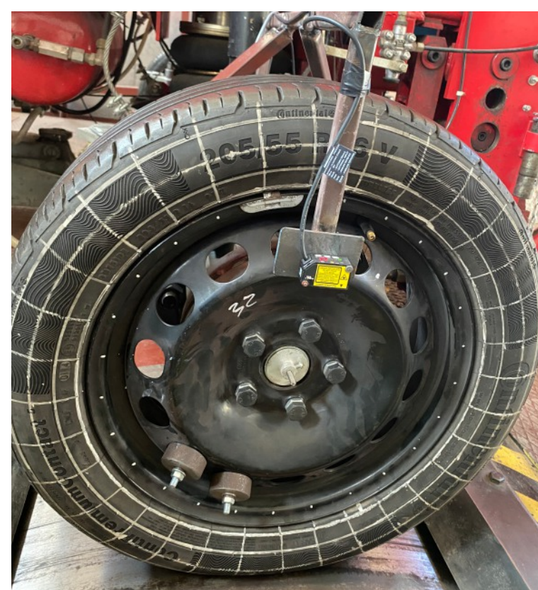
Badane koło z zamontowanymi dwoma dodatkowymi masami
