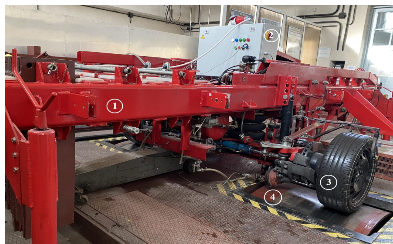
Stanowisko pomiarowe: 1) przyczepa dynamometryczna, 2) skrzynka sterownicza, 3) badane koło, 4) bęben napędowy
