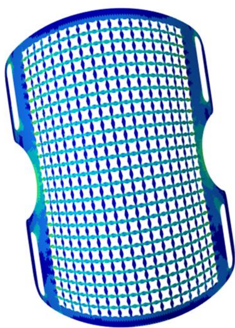
Mapa naprężeń zredukowanych (MPa) – wariant I
