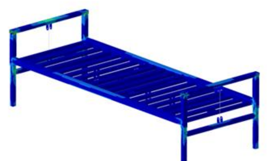
Mapa naprężeń zredukowanych modelu łóżka
